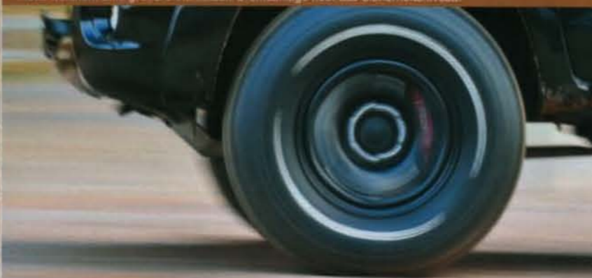
Mehr Antriebsleistung verlangt beim Hilux nach mehr Bremsleistung. Die 15-Zoll-Serien-Bremse muss weichen. Eine größere Vierkolben-Bremsanlage hebt das Sicherheitsniveau.
