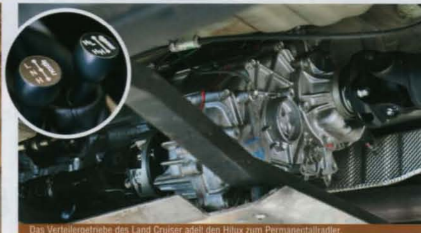
Das Verteilergetriebe des Land Cruiser adelt den Hilux zum Permanentallradler.
